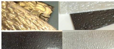
Pleksilevyt, simpukka jäljitelmää, näyttää kuin pinnalla olisi isojen vesipisaroiden muodostamia kuvioita. Pintakuviosta saa vaikutelman että pinta on rypyläinen, vaikkakin se on sileä. Levy paksuus hieman yli 3mm, kovaa pleksiä. Levy valmistustekniikasta johtuen levyt eivät ole suoria vaan voivat olla kaarevia. Ei käytetä kitaroiden pleksilevynä. Käytetään koristeupotuksissa, kalusteissa, potikan nuppien päissä, puukoissa, jne... Levy koko n. 25cm x 55 cm.
